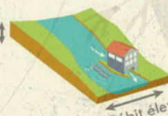
Centrale de basse chute
